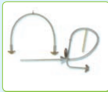
Εύκαμπτοι σωλήνες σύνδεσης για μετάγγιση υγρού αζώτου
